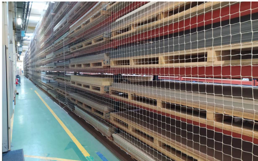
Stockage plaques PVC-PET (5 m de hauteur)
