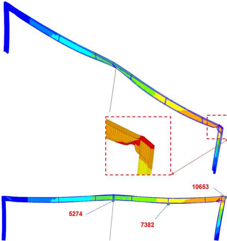
Figure 32 : Déformation visuelle du portique sous le feu ISO à t=788s (exagérée : x5)
